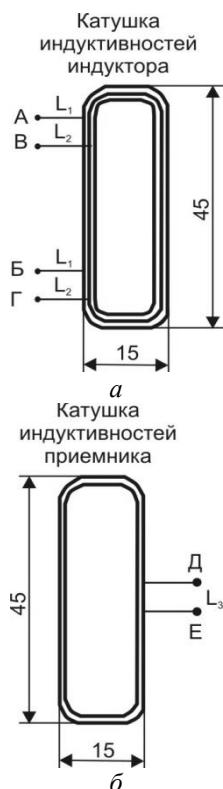
Рис. 1. Конструкция катушек индуктивности качера [1]
